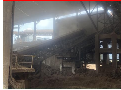
ภาพที่ 2.2-49 สายพานลำเลียงใบอ้อยที่ผ่านกระบวนการ ย่อยลดขนาดแล้ว
