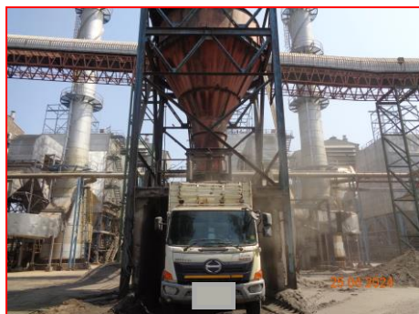
ภาพที่ 2.2-14 การขนถ่ายลงสู่ท้ายรถบรรทุก
